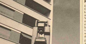
Die Firma MBT bietet mit dem Leica-System eine gerüstfreie Fassadenvermessung
