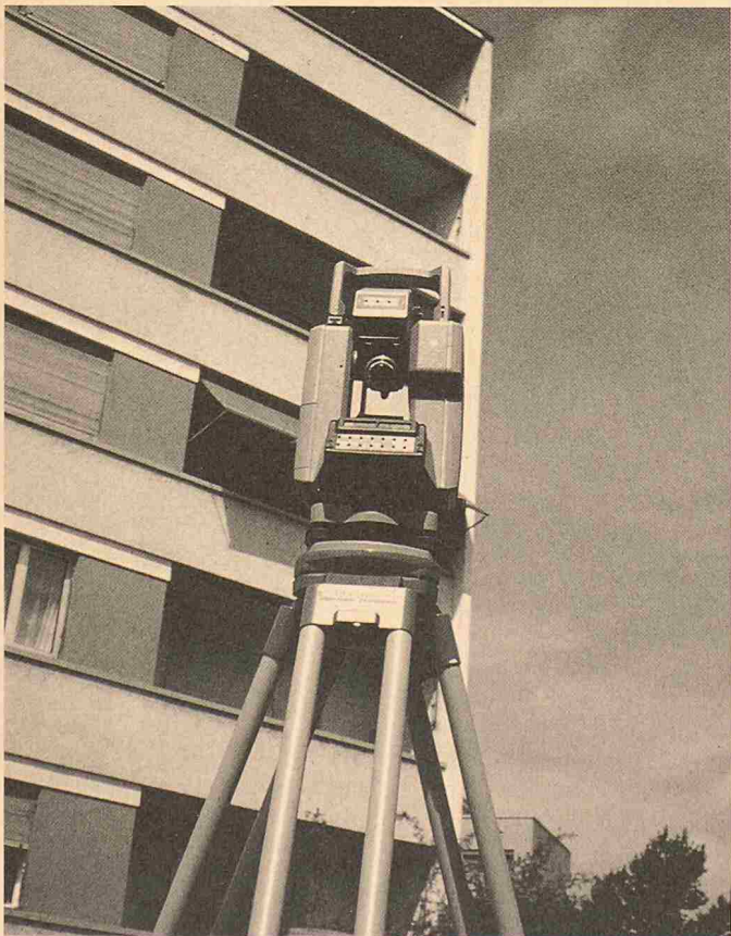
Die Firma MBT bietet mit dem Leica-System eine gerüstfreie Fassadenvermessung
