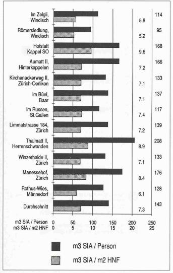
Bild 8. Vergleich von Kubatur pro Person (m³ SIA/Person) und Kubatur pro Hauptnutzfläche (m³ SIA/m² HNF)
