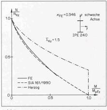
Bild 2. I PE 240 unter Druck und Biegung um die schwache Achse,  $\lambda_{\rm Kz}$  = 1,5. Vergleich des Interaktionsdiagrammes aus «genauen» Untersuchungen mit der Formel (47) der Norm SIA 161/1990 und mit der stark unsichere Ergebnisse liefernden Formel (10) des Aufsatzes.
