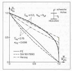
Bild 1. HEA 200 unter Druck und Biegung um die schwache Achse. Obere Kurven für den Querschnittswiderstand, untere Kurven für  $\bar{\lambda}_{Kz} = 0.75$ . Vergleich des Interaktionsdiagrammes aus «genauen» Untersuchungen mit der Formel (44) bzw. (47) der Norm SIA 161/1990 und mit der deutlich unsichere Ergebnisse liefernden Formel (4) bzw. (10) des Aufsatzes.
