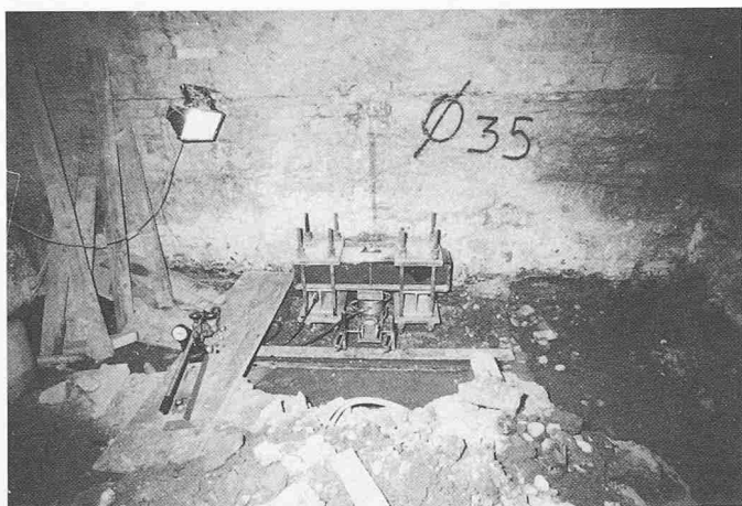
Bild 4. Probestahl-Dispositiv im Keller. Probestbelastungen wurden paarweise unter gleichzeitiger Belastung der Pfähle durchgeführt.
