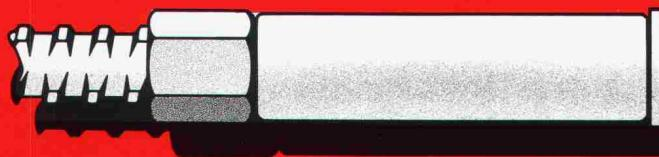
Gewi-Muffenstoss, halbseitig einbetoniert
