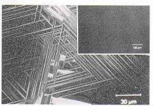
Das Gefüge einer Legierung, die spröde Ausscheidungen enthält. Im oberen Feld rechts das Gefüge einer vollständig homogenen Einkristallegierung
