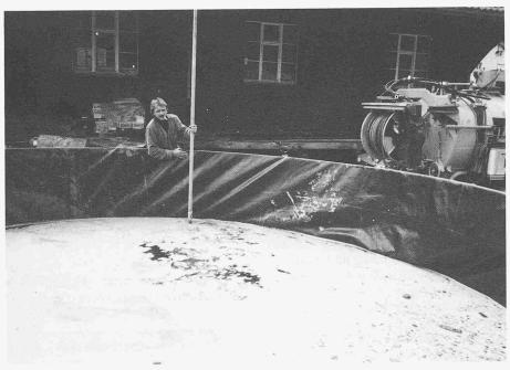
Bild 3. Mobiler Schnellmontage-Behälter im Katastrophen-Einsatz, Inhalt 45 000 Liter (Rückhaltung von durch Farben und Lösungsmittel kontaminiertem Überschwemmungsgut)
