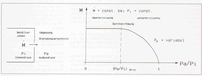
Bild 5. Ausströmvorgang an einer Blende, kritisches Druckverhältnis
