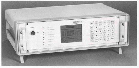
Bild 4. Auswerteelektronik des mikroprozessorgesteuerten Durchflussmessgerätes LDV 200 mit LCD-Anzeige und Folientastatur
