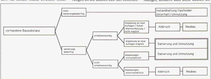
Bild 2. Schema «Eingriffsmöglichkeiten in die bestehende Bausubstanz», P. Meyer
