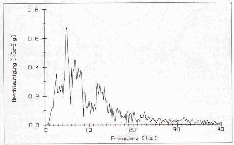
Bild 7. Fourier-Amplituden-Spektrum der Ost-West-Komponente des Bebens von Bild 6.
