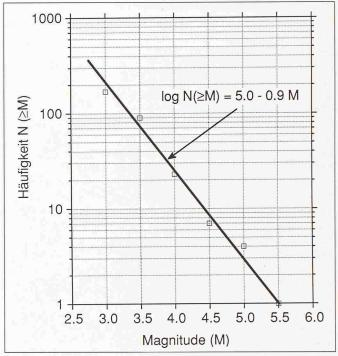
Bild 4. Häufigkeit der Erdbeben im Zentralwallis zwischen 1940 und 1990 mit einer Magnitude ≥ M.
