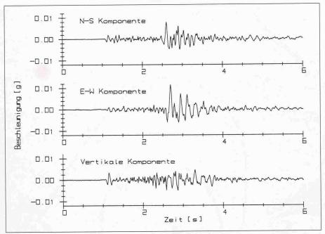
Bild 6. Beschleunigungs-Zeitverlauf des Bebens vom 30.9.1989 (M = 3.8) an der Station in Grimisuat (Epizentraldistanz 6 km).
