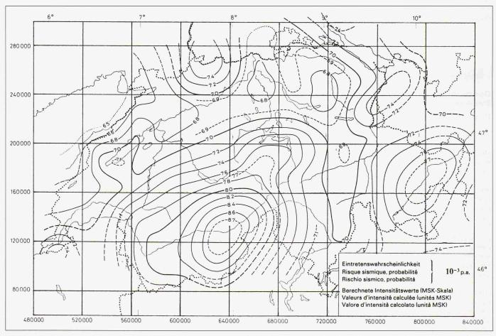
Bild 1. Erdbebengefährdung in der Schweiz: Karte mit Linien gleicher Intensität I (MSK-Skala) für eine mittlere, jährliche Auftretenswahrscheinlichkeit von 10<sup>-3</sup>. Dies entspricht einer statistischen Wiederkehrperiode von 1000 Jahren (aus [1]).
