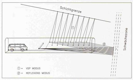
Bild 1. Messprinzip tunnelseismisches Profiling (TSP)
