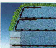
Mit Tensar SR Geogittern können die unterschiedlichsten Füllmaterialien und Frontverkleidungen verwendet werden.
