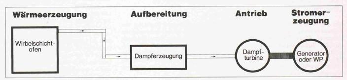
Bild 2. Wärmekraftkopplung mit Wirbelschichtofen (mit oder ohne Abgasreinigung) und Dampfturbine
