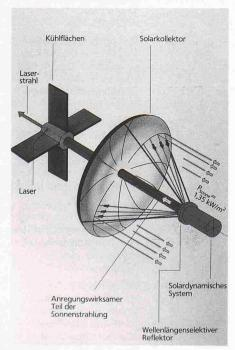
Solargepumptes weltraumgestütztes Lasersystem (Bild: DLR)
