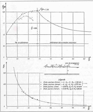
Bild 4. Maximale Wellenhöhe h\*max/ h' und Wellenlänge e/h' der positiven Schwallwelle in Abhängigkeit von der relativen Schwallhöhe h'/H (Favre, 1935a)
