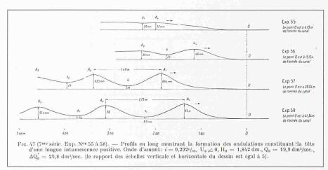
Bild 3. Längenprofile der positiven Schwallwelle, 7. Serie (Favre, 1935a)
