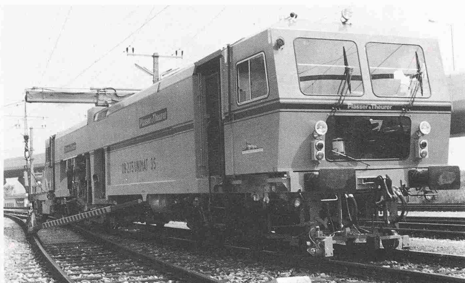
Bild 8. Universal-Stopmaschine für die Durcharbeitung von Gleisen und Weichen (Unimat 08-275)
