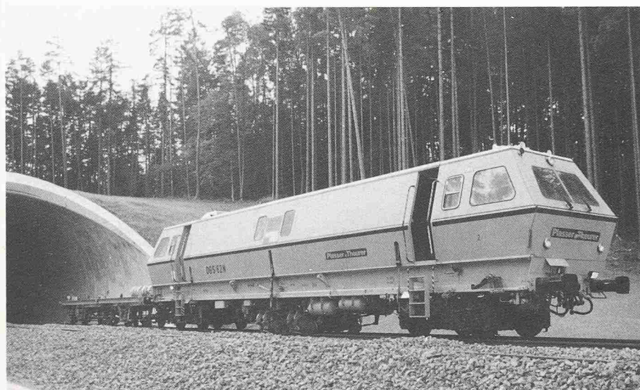
Bild 9. Dynamischer Gleisstabilisator (DGS-62 N) mit Messanhänger und 6-Kanal-Schreiber
