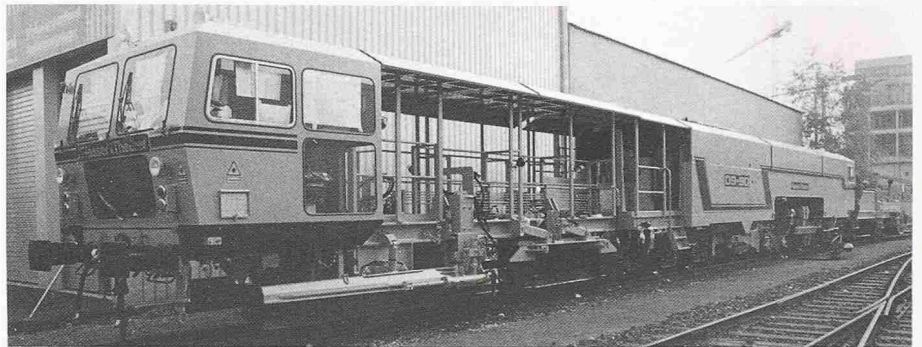
Bild 6. Stopfmaschine mit automatischer Schotterprofilierung (09-90)
