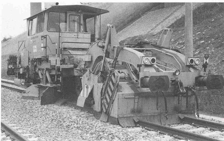
Bild 5. Hochleistungs-Schotterplanier- und -profiliermaschine für Gleise (SSP 110) und Weichen (SSP 110 SW) – mit Schottersilo
