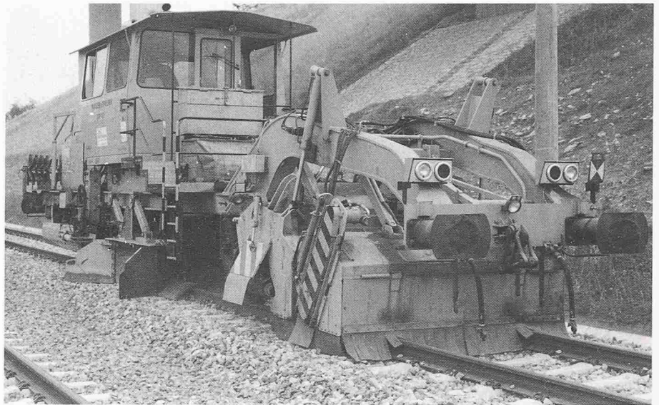
Bild 5. Hochleistungs-Schotterplanier- und -profiliermaschine für Gleise (SSP 110) und Weichen (SSP 110 SW) – mit Schottersilo
