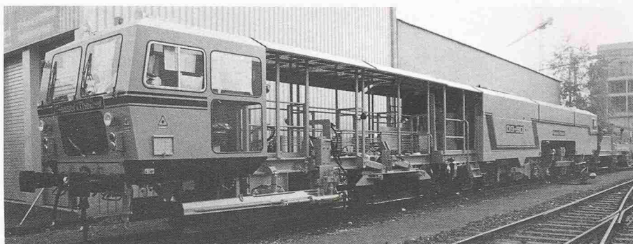
Bild 6. Stopfmaschine mit automatischer Schotterprofilierung (09-90)
