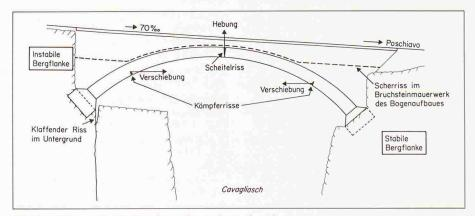
Bild 2. Längsschnitt alte obere Cavagliascobrücke
