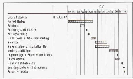
Bild 6. Projektierungs- und Bauprogramm
