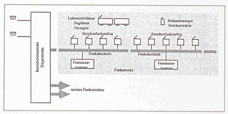
Bild 1. Zugfunk, Netzaufbau
