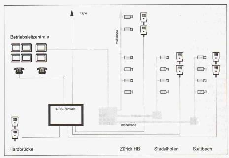
Bild 5. Blockschaltbild Info-Notrufsäulen und Videoanlage
