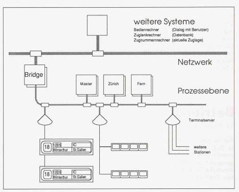
Bild 4. Blockschaltbild Fahrgastinformationsanlage
