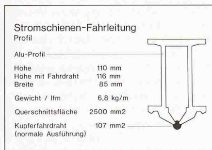
Bild 7. Profil Stromschienen-Fahrleitung
