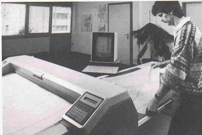
Bild 13. Automatische Planerfassung mit einem Grossformat-Scanner (Quelle Multitec)
