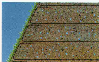
Die Bewehrung mit Tensar SR Geogittern ermöglicht die natürliche Begrünung von Böschungen.
