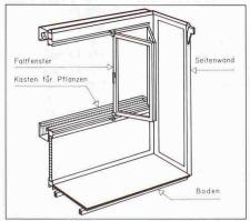
Bild 4. Skizze Balkonerker mit Faltfenster
