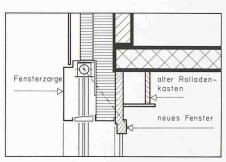
Bild 2. Schnitt Fenstersturz, saniert mit neuem Fenster
