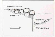
Bild 5. Querschnitt durch das neue Tösswehr, welches aus einem zweistufigen Absturz, aufgestützt auf einer Spundwand, besteht. Der Kolk unterhalb dem Wehr dient den Fischen als Lebens-
