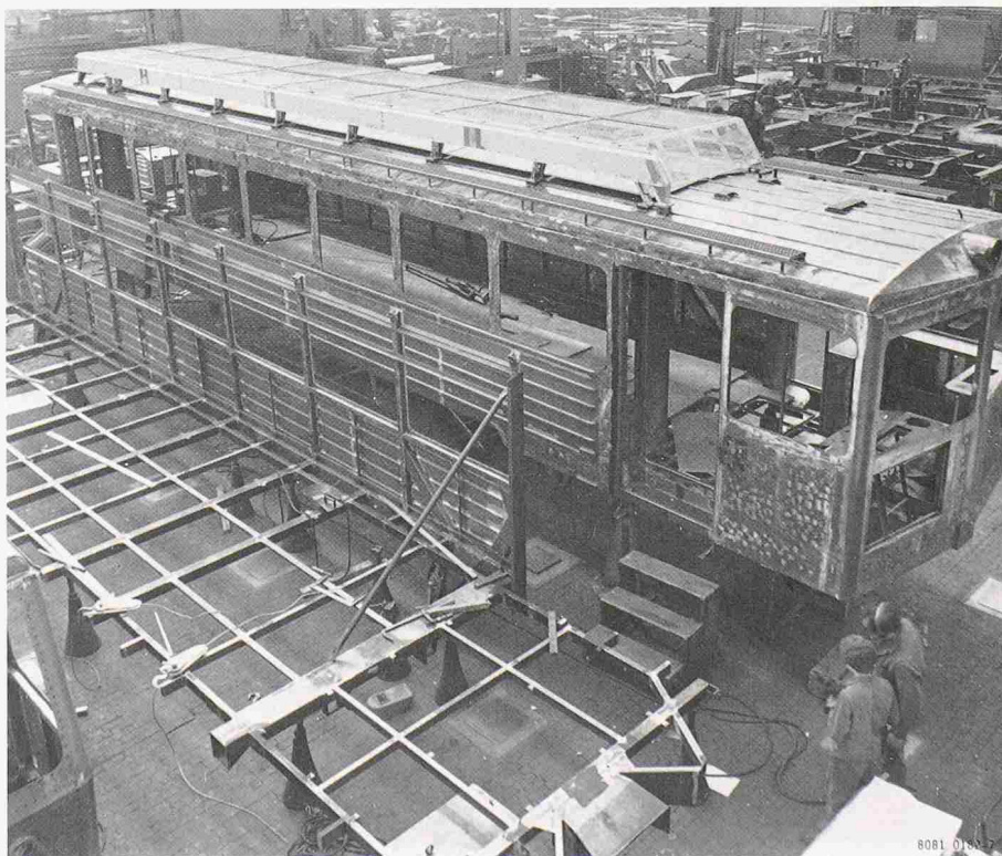
Rohkasten eines Triebwagens, im Vordergrund der Bodenrahmen eines Steuerwagens mit Seitenwand. Am unteren Bildrand in der Mitte der Kupplungstunnel mit Fachwerk.
