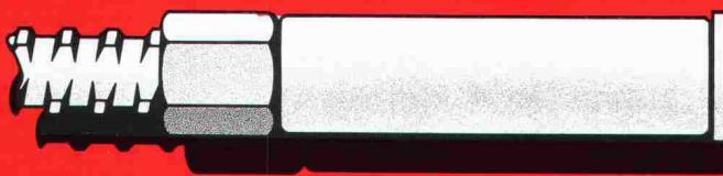
Gewi-Muffenstoss, halbseitig einbetoniert
