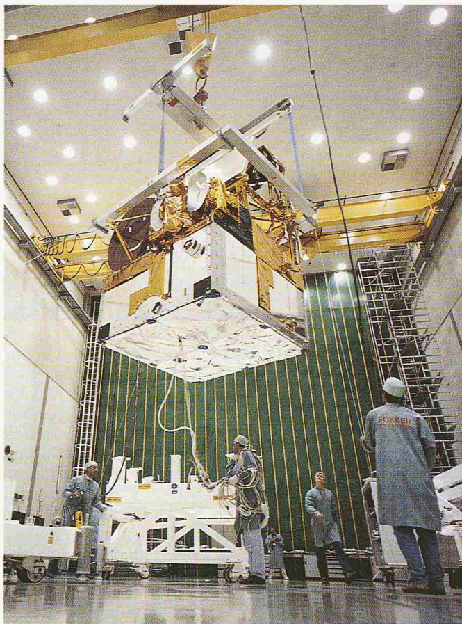
Bild 8. Nutzlastmodul mit wissenschaftlichen Experimenten. Die Struktur wurde durch Contraves in Zürich gebaut. Courtesy of: ESA/Archiv Schmidt.
