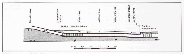
Bild 2. Längenprofil, überhöht
