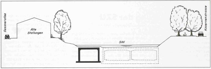
Bild 3. Querprofil in der Sihl mit SZU-Verlängerung und geplanter Sihltiefstrasse
