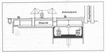
Bild 4. Querprofil durch die SZU-Station Hauptbahnhof
