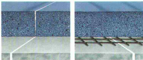
Forschungen der Universität von Nottingham haben bewiesen, dass z.B. Reflektionsrisse durch die Bewehrung mit Tensar AR1 vollständig verhindert werden können.
