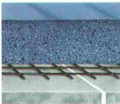
Forschungen der Universität von Nottingham haben bewiesen, dass z.B. Reflektionsrisse durch die Bewehrung mit Tensar AR1 vollständig verhindert werden können.
