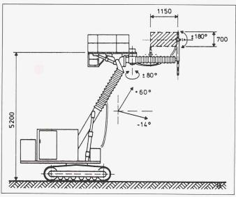
Bild 8. Japanischer Spritzroboter mit elektronischer Positionsbestimmung (Maidl)
