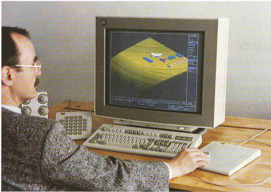
Bild 2. CATIA ist lauffähig auf IBM-Zentralrechnern der /370- und /390-Serie sowie auf IBM-Workstations 6150 und der neuen Workstation-Familie IBM RISC System/6000. Der Arbeitsplatz besteht aus dem hochauflösenden Graphikbildschirm (19 oder 23 Zoll), dem Tablet mit Cursor, der alphanumerischen Tastatur, der Funktionstastatur, dem Wertgeber und dem Bildschirmprozessor. Die Konfigurationen ergänzen sich je nach Bedarf mit diversen Ausgabegeräten wie Plotter, Bildschirmdrucker, Laserdrucker usw. Weltweit sind über 15 000, in der Schweiz über 300 Arbeitsstationen im Einsatz. Im Bauwesen bleibt die Anwendung nicht auf die Architektur beschränkt; alle Aspekte der Bau- und Haustechnik können computerintegriert und interdependent bearbeitet werden.
