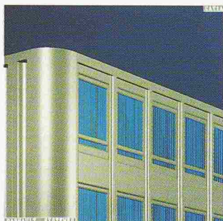
Bild 25. Fotorealistische Darstellung der Variante von Bild 24. Das CATIA-Modul «Image Design» erlaubt die Erzeugung von farbigen Bildern, wobei sich verschiedene Lichtquellen, Materialoberflächen und Transparenz definieren lassen.
