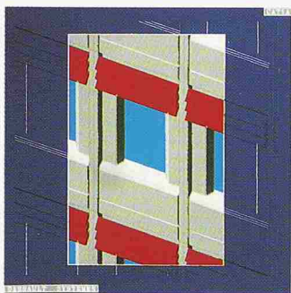
Bilder 20/21. Interaktive Einfärbung von Fassadenvarianten. Am Bildschirm kann ein beliebiger Ausschnitt des 3D-Modells für die Einfärbung gewählt werden. Diese interaktive Einfärbungsmöglichkeit ist in den Basismodulen für 3D enthalten.
