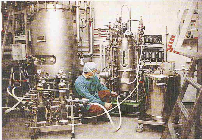
Bild 5. Ein 50-l-Fermenter wird für die Produktion von menschlichen Hormonen mit rekombinierten tierischen Zellen «aufgetankt». Für den Sterilbetrieb sind aseptische Kleider notwendig, um eine Infektion des Fermenters zu vermeiden (Bild: Laboratoires Serono, Aubonne)
