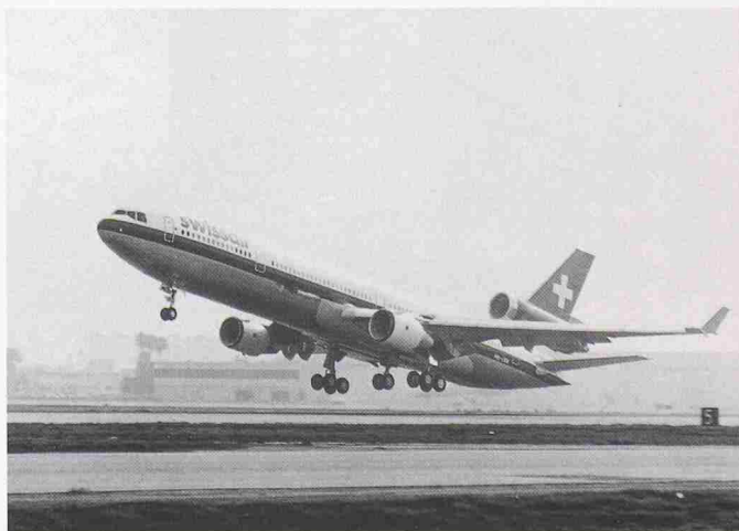
Die MD-11 löst als Langstreckenflugzeug die DC-10 ab. Der neue Trident fliegt leistungsstärker, aber schadstoffärmer und verursacht weniger Lärm
