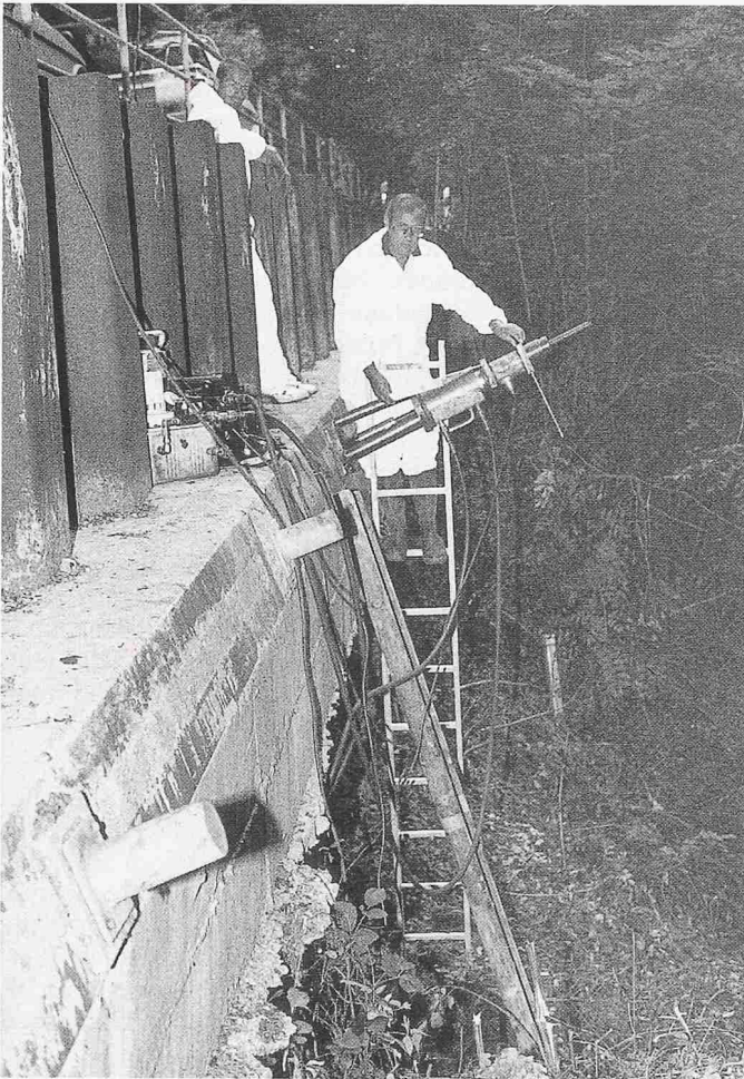
Bild 1. Leichte, tragbare Spannpressen erlauben Prüfungen auch an schwer zugänglichen Stellen
