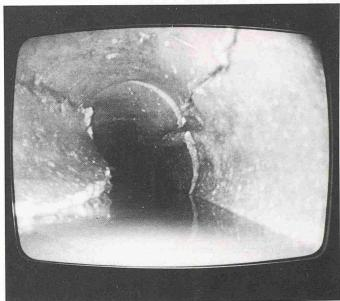
Bild 13. Fernsehaufnahme eines geborstenen und stark deformierten Abwasserkanals
