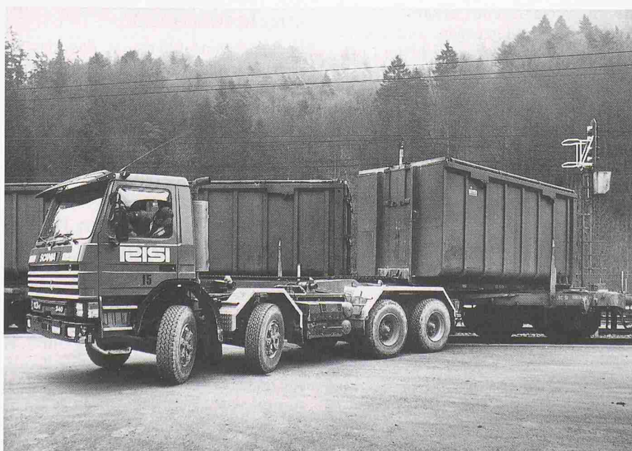
Mit dem ACTS-System kann eine einzige Bedienungsperson in Minutenschnelle den Container vom Lastwagen auf den Eisenbahnwagen oder umgekehrt verladen (Bild: Comet)
