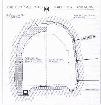
Bild 4. Normalprofil vor/nach der Sanierung
