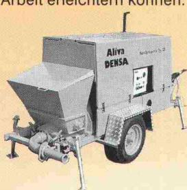
Für das Nass-Spritzverfahren haben wir deshalb ein völlig neues Funktionsprinzip entwickelt, welches dem Profi Vorteile bringt. Erstmals wird das Spritzgut geradlinig gefördert, was die Strömungs- und Druckver-
