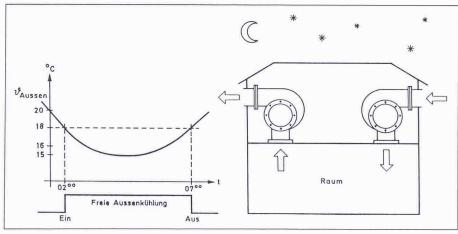
Bild 3. Der Nachtkühlbetrieb stützt auf die thermische Speicherfähigkeit von Gebäuden ab. Mit diesem Programm, das sich auf den Sommerbetrieb beschränkt werden Gebäude in der Nacht mit kälterer Aussenluft vorgekühlt. Damit nicht unnötige Kühlenergie für die Luftförderung aufgebracht werden muss, setzt der Nachtkühlbetrieb erst ein, wenn zwischen Referenzraum- und Aussenlufttemperatur eine genügend grosse Differenz herrscht
