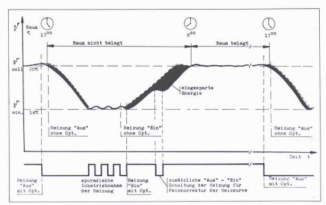
Bild 1. Gleitendes Ein- und Ausschalten haustechnischer Anlagen, hauptsächlich von Heizungen, optimiert Aufheiz-, Heiz- und Absenkzeiten. Die entsprechenden Ein- und Ausschaltparameter werden durch Erfassen der Aussentemperatur, der Restwärme des Gebäudes und aus der empirischen Erfassung des Temperaturverhaltens des Gebäudes ermittelt. So lässt sich der optimale Einschaltzeitpunkt bestimmen, um eine möglichst wirkungsvolle Aufheizzeit und damit geringsten Energieaufwand zu erreichen
