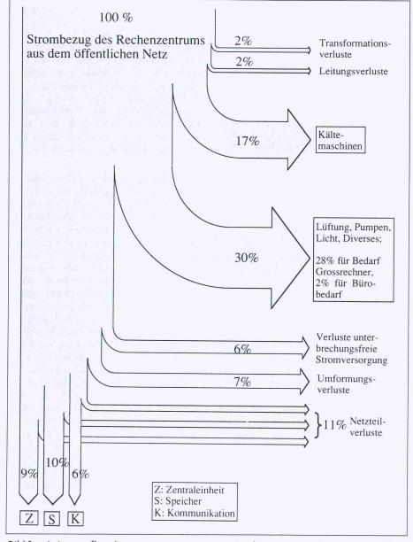
Bild 1. Leistungsflussdiagramm eines grossen Rechenzentrums (gemessene Werte wurden um 14 Uhr am 30.1. 1989 aufgenommen, aus [2]). Total: 3,9 MW
