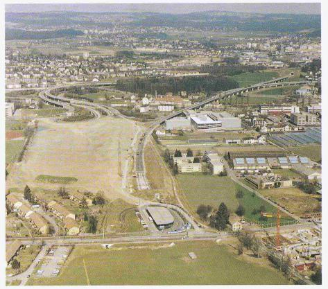
Bild 2. Nach dem Bau der S-Bahn (1990); Vordergrund: Landwirtschaftlich rekultiviertes Krummpünt, Station Stettbach, Bildmitte: Mit Tunnelausbruchmaterial gestaltete Stettbacherwiesen (Erholungsflächen, Lärmschutzhügel), gegen Hintergrund: S-Bahnviadukt Neugut und Tunnelportal Föhrlibuck (Aufnahmen: Militärflugdienst Dübendorf)
