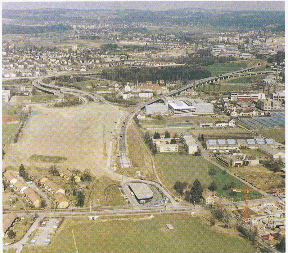
Bild 2. Nach dem Bau der S-Bahn (1990); Vordergrund: Landwirtschaftlich rekultiviertes Krumpfünt, Station Stettbach, Bildmitte: Mit Tunnelausbruchmaterial gestaltete Stettbacherwiesen (Erholungsflächen, Lärmschutzhügel), gegen Hintergrund: S-Bahnviadukt Neugut und Tunnelportal Föhrlibuck (Aufnahmen: Militärflugdienst Dübendorf)
