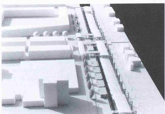
Bild 4. Die Tieflegung der Bahn ermöglicht die freie Führung der verschiedenen Verkehrswege à Niveau und vermindert die Trennwirkung der Bahnlinie zwischen den einzelnen Quartierteilen. Projektverfasser: Andreas Rietmann
