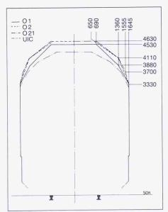
Bild 4. Bezugslinien im Fahrzeugquerschnitt
