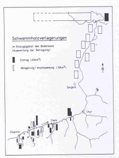
Bild 2. Schwemmholzverlagerung im Einzugsgebiet des Bodensees, aufgezeichnet aufgrund der Umfrageergebnisse
