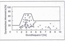
Bild 1. Empfindlichkeit der Haupttragelemente von Strassenbrücken auf die dynamischen Wirkungen eines einzelnen Lastwagens in Abhängigkeit von ihrer Grundfrequenz [1]
