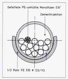
Bild 4. Spannkabel auf einem Umlenksattel bei einem Zwischenauflager
