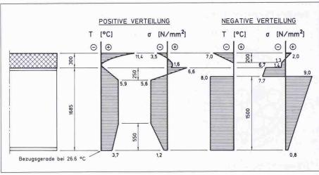
Bild 2. Positive und negative Temperaturverteilung mit entsprechenden Spannungen in einem Verbundquerschnitt
