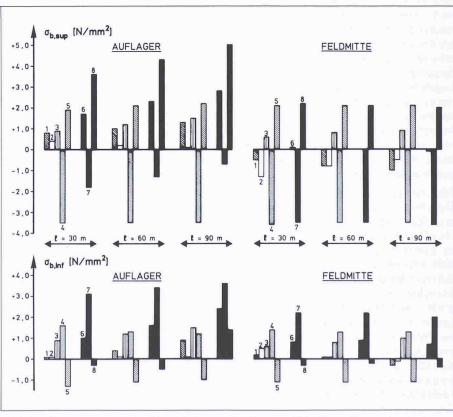
Bild 1. Spannungen in der Platte infolge ständiger und häufig auftretender Lasten
