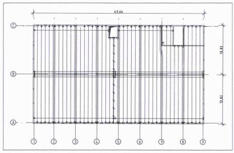
Bild 2. Gebäudegrundriss und Kabelverlauf für die Decken
