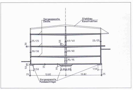
Bild 1. Schnitt durch die Tragkonstruktion
