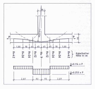
Bild 4. Kabelverlauf im Fundamentriegel
