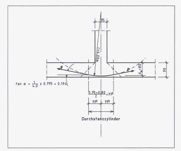
Bild 5. Entlastung aus Vorspannung im Durchstanzzylinder
