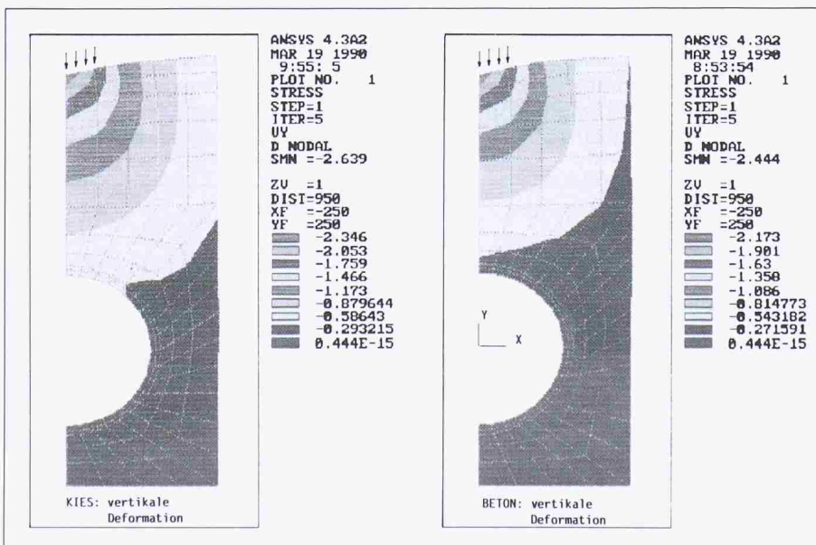
Bild 5. Berechnete Verteilung der Vertikalverschiebungen infolge Eigengewicht und einer Radlast von 61,4 kN bei Kies- und Betonbettung für einen Graben-Elastizitätsmodul von E_k = 110 \text{ N/mm}^2
