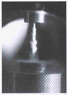
Kurzzeitaufnahme des Wasserdampfstrahls mit Strahlkavitationsprüfstand (Bild: Sulzer)
