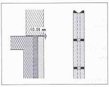
Festigkeit für MCNC-Mauerwerk (eta = 0,1k/d = 8) von 9 N/mm². Die Verformung einer 2,5 m hohen Wand aus tragendem Sikkerstein unter diesen ungünstigen Bedingungen unter einer 7,5 m hohen Aussenschale beträgt dann (E-Modul nach Lit. [1]) etwa 0,04 mm! Eine Einsenkung in dieser Grössenordnung wird aber nie zu Problemen führen
