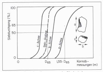
Bild 6. Verteilung der Abmessungen der Blockmischung
