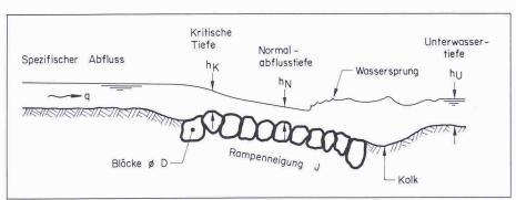
Bild 4. Prinzipskizze einer Blockrampe
