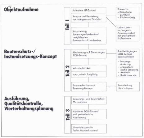
Bild 1. Ablaufschema der Mauerwerksanierung
