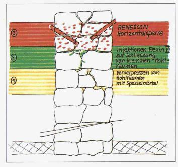
Bild 3. Dreischichtiger Injektionsaufbau für Horizontalsperre
