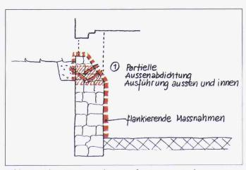
Bilder 5 und 6. Horizontalsperren für Aussenwände
