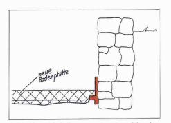
Bild 11. Abdichtungen im Anschlussbereich Bodenplatte/Wände
