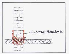
Bild 4. Horizontalsperre für Zwischenwände
