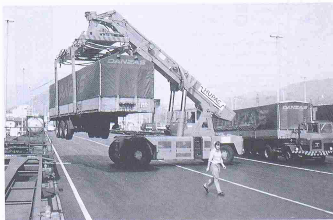
Per Huckepack werden nach den nötigen Anpassungsarbeiten auch Fahrzeuge bis zu 40 t mit der Bahn die Schweiz durchqueren können (Bilder: A. Gfeller, SBB)
